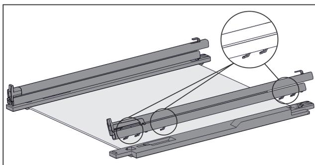
Fig. 53 Skleněná deska s kolejničkami a přídržnými díly
